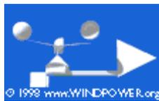
La mesure de la vitesse du vent se fait le plus souvent par l'emploi d'un anémomètre à coupelles comme celui de l'image de gauche. Un tel anémomètre est muni d'un rotor de trois coupelles qui, sous l'effet du vent, se met à tourner autour d'un axe vertical. La vitesse de rotation est enregistrée électroniquement.
