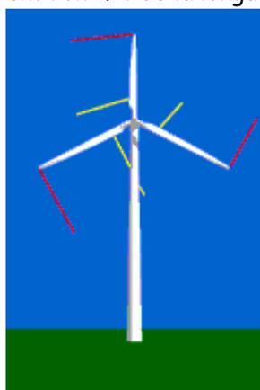
Après, nous laissons les rubans flotter librement dans l'air (sur l'animation, nous n'avons pas tenu compte des filets d'air créés par les pales mêmes, ni de la force centrifuge).
